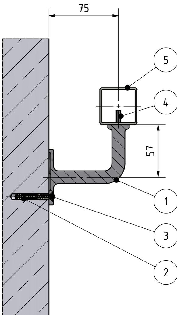
1. Handlaufstütze für Wandbefestigung, Handlauf flach MOD 0104
