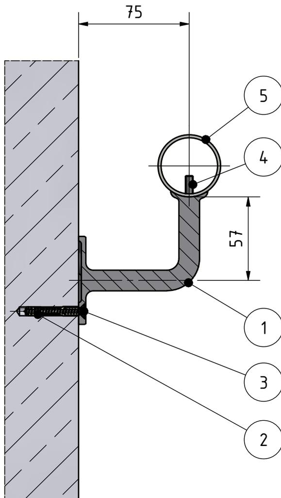
1. Handlaufstütze für Wandbefestigung, Handlauf Ø42,4 MOD 0104
