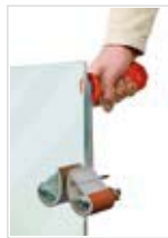
Plaat-/glasdrager Spanwijdte: 0 tot 80 mm. Max. belasting per stuk: 100 kg.
